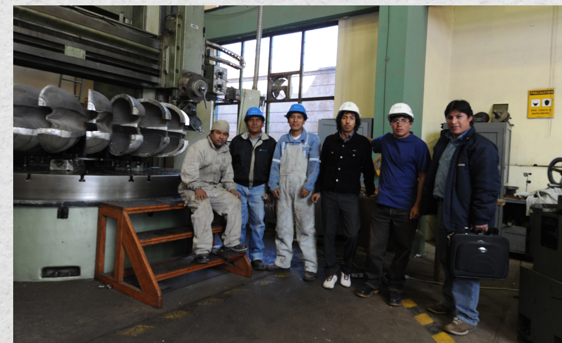
Mantenimiento de rodete Pelton en torno vertical, Taller Central.
